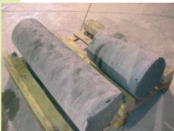
Figure 4 : Carotte de la série argileuse provenant des galeries d'explorations à 490m de profondeur.
